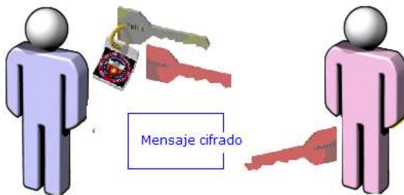
Fig.: El usuario de la izquierda dispone de ambas claves y cifra un mensaje con la clave privada. El de la derecha sólo necesita la clave pública para descifrar.
